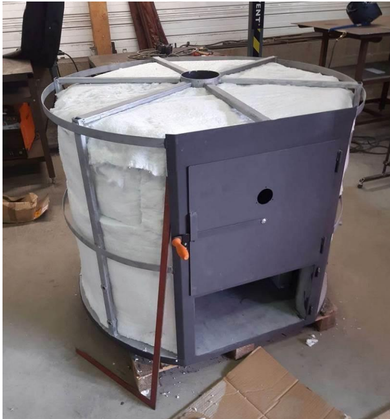
Une première couche d'isolant haute température (laine de céramique épaisseur 50mm utilisée par l'Atelier Paysan) « côté chaud ».
