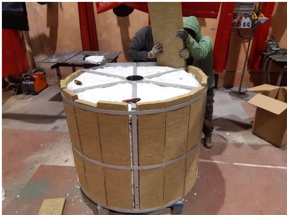
Une deuxième couche en laine de roche classique (ici en panneau rigide, mais plus simple en panneaux souples, épaisseur 45mm)
